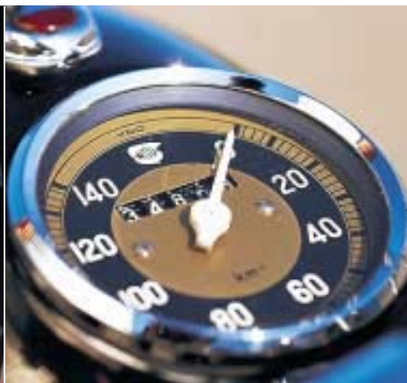
Überschaubares Instrumentarium mit Tacho sowie Leerlauf- und Ladekontroll-Leuchte in einem
