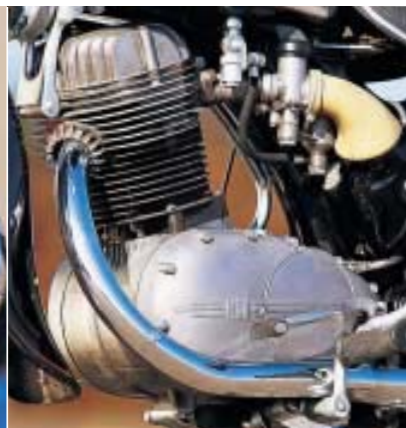
Schnörkelloser, sportlicher Einzylinder mit „Ultramaxsteuerung“ der obenliegenden Nockenwelle
