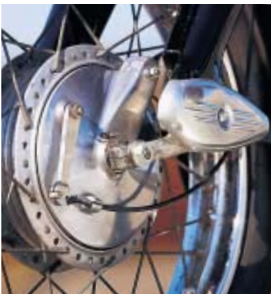
Simplex-Trommelbremse mit Bremsnickausgleich, dank Kurzschwinge und Bremsmomentabstützung
